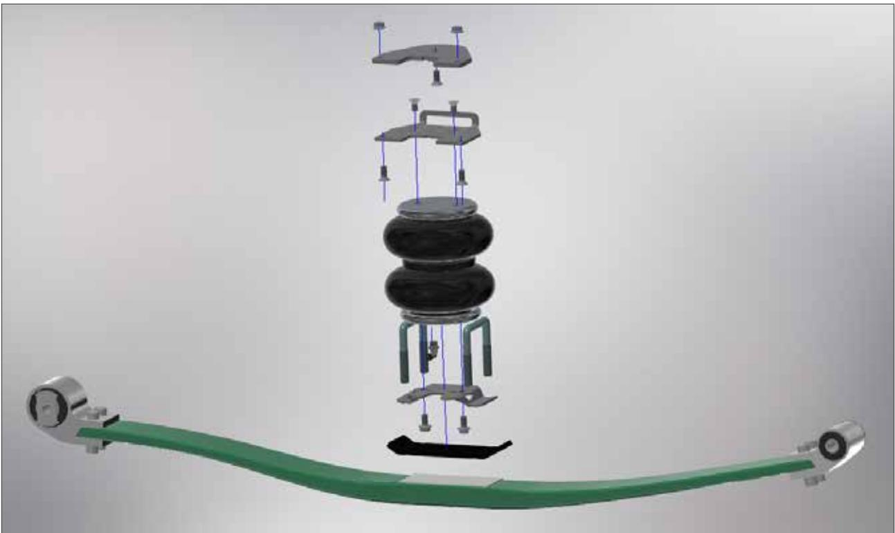
Komponenten des RouteComfort für die Hinterachse
