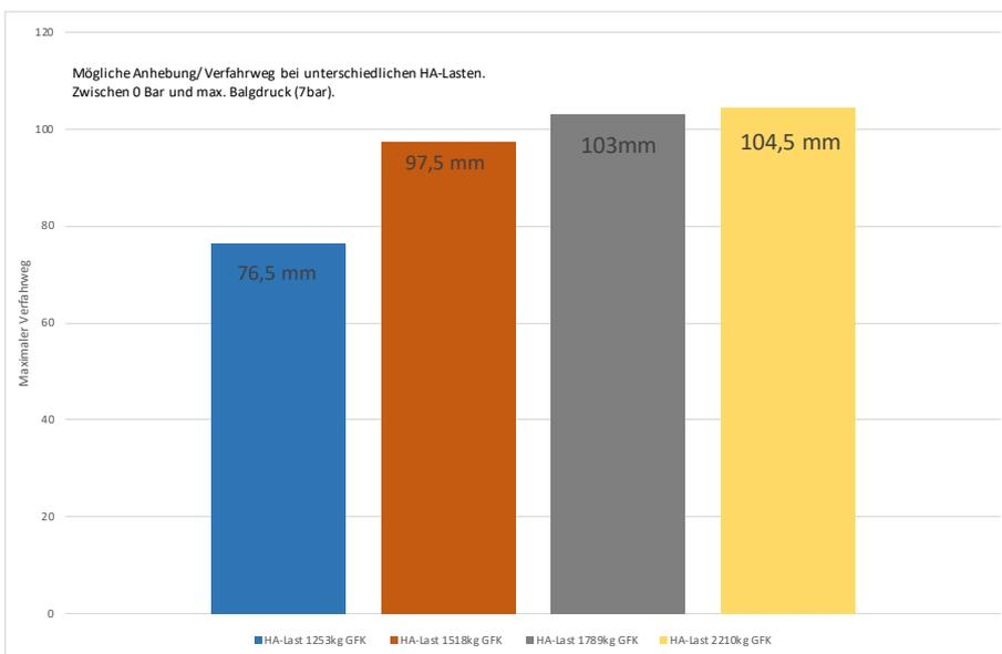
möglicher Verfahrweg der ZLF (in Abhängigkeit der tatsächlichen Hinterachslast)
